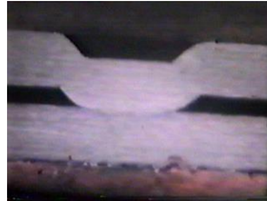
Buckelschweißung 50Hz 1,5+1,5mm Blechpaarung
