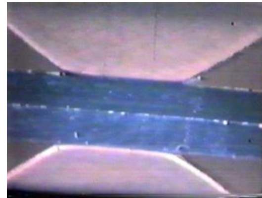
Zweiblech- Punktschweißung 1000Hz 1,5+1,5mm Blechpaarung
